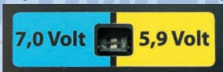
Um die Ausgangsspannung umzustellen, schalten Sie die Weiche vor dem Umstellen aus. Verwenden Sie einen spitzen Gegenstand ( Nadel oder kleiner Schraubenzieher ), und bewegen beide DIP Schalter in die gewünschte Position.
