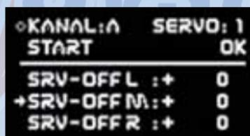
Achten Sie darauf, dass die Matchkanäle die eingestellt werden sollen, vorher wie im Punkt 3.7. initialisiert wurden. Es wird empfohlen Servo 1 des jeweiligen Kanals in der Mittenstellung mechanisch so anzupassen, dass das Ruder gerade steht. Vor dem Matchen sollte auch der Maximale Weg und die Expo Funktion eingestellt sein. Die Programmierung ist auch hier äußerst einfach gestaltet, gehen Sie Schritt für Schritt wie folgt vor:
