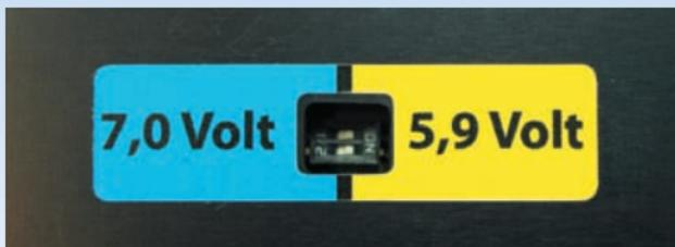
Um die Ausgangsspannung umzustellen, schalten Sie die Weiche vorher aus. Verwenden Sie einen spitzen Gegenstand (Nadel oder kleiner Schraubenzieher), und bewegen beide DIP Schalter in die gewünschte Position.
