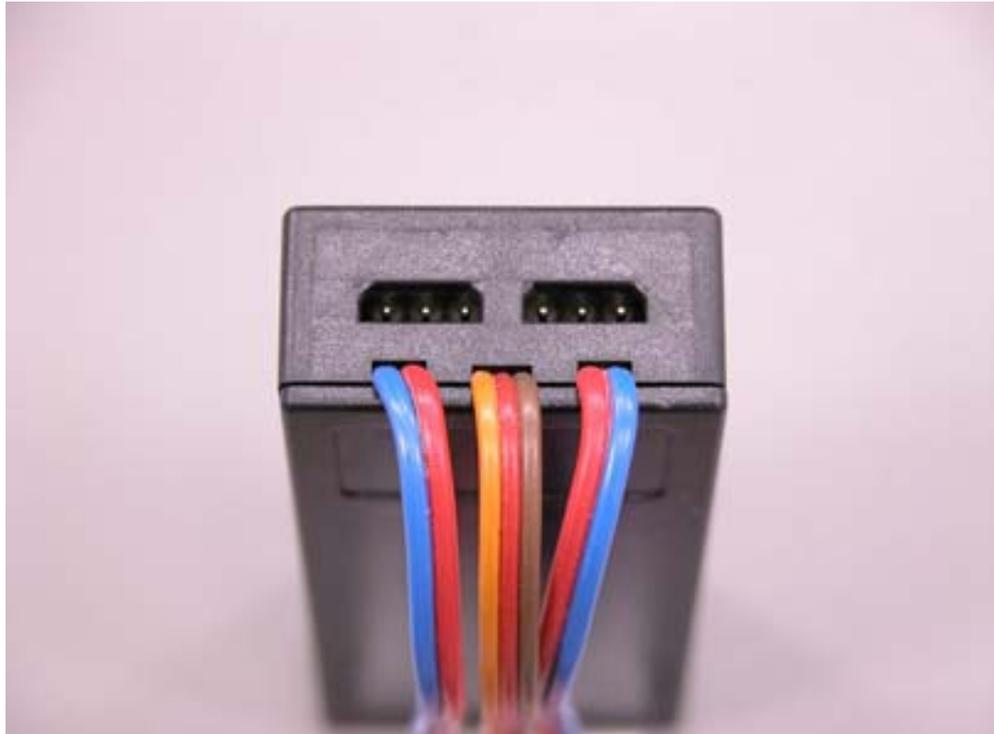
电源经过 2 根舵机导线（横截面为  $0.34\text{mm}^2$ ，蓝色/红色）传输给接收机和所有舵机。导线应与接收机上标注有“B”（电池）字符的插口和其它的空通道输出插口连接。
