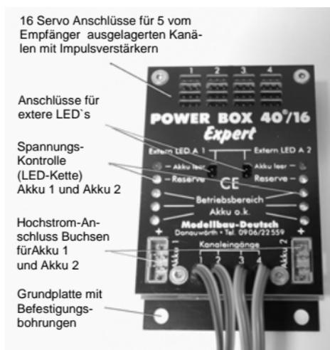
Der Anschluss der beiden Akkus erfolgt über die beiden Hochstrombuchsen. Prinzipiell funktioniert die **PowerBox 40/16 Expert** auch mit einem Akku, die Sicherheit einer Doppelstromversorgung ist dann aber nicht gegeben.
