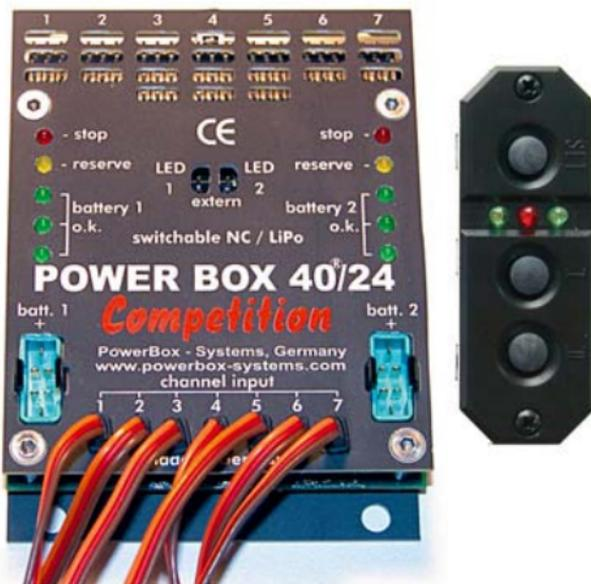
mit doppelter, linear geregelter Spannungsstabilisierung
