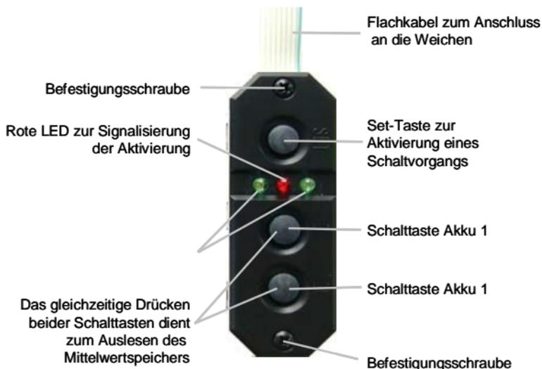
Die etwas abgesetzte **SET** – Taste dient zur Vorbereitung und Ausführung eines Schaltvorganges. Durch das „**Gedrückt-Halten**“ der **SET** Taste werden die Schalter „scharf“ geschaltet. Nach ca. 1 Sekunde leuchtet die rote LED auf. Die elektronischen Schalter sind aktiviert und bereit geschaltet zu werden.
