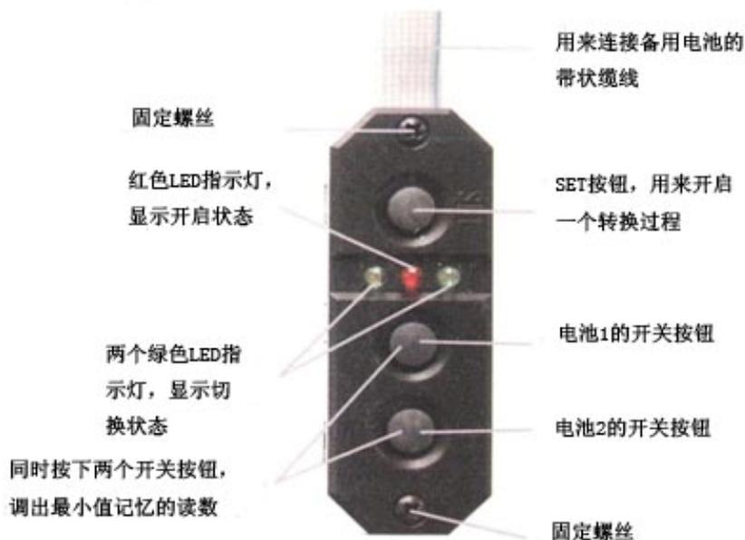
SET 按钮稍微凹进，用来准备和执行一个转换过程。持续按住 SET 按钮以激活转换过程：约 1 秒钟后，红色 LED 指示灯常亮。这表明电子开关已准备好进行切换。
