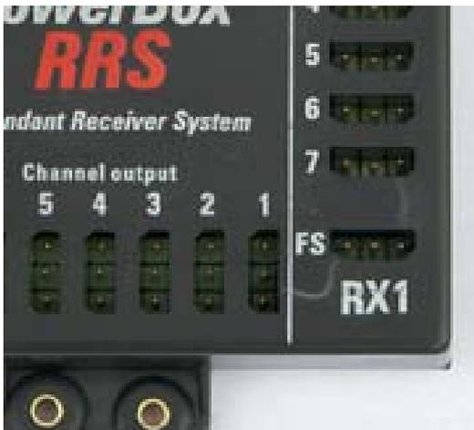
图中显示“失控保护”插口与两个接收机的 7 个通道输入端离得很近；在 RRS 模块上“失控保护”插口的标注符号为“FS”。此插口应该与在发射机中编程为失控保护的一个接收机通道连接。
