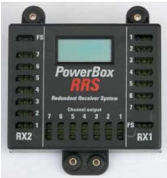
接收机 2 的 7 根连接导线的插口 (RX 2)
