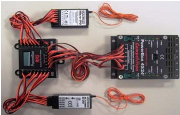
Im folgenden Bild können Sie die Steckweise am Beispiel einer **PowerBox Evolution** erkennen. Der Futaba G3 Empfänger ist mit 7 Kanälen und dem Failsafe-Kanal am **RRS-Modul** angesteckt. Da die **PowerBox Evolution** nur 5 Kanäle versorgt, verbleiben zwei freie Steckplätze am **RRS-Modul** für zwei weitere Servos. Alle weiteren Kanäle des Futaba G3 Empfängers könnten am Empfänger ebenfalls direkt genutzt werden.
