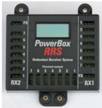
Der Failsafe-Kanal (Buchse FS) muss ebenfalls wie bei Empfänger 1 belegt sein, dieser Kanal muss auch auf Failsafe programmiert sein.
