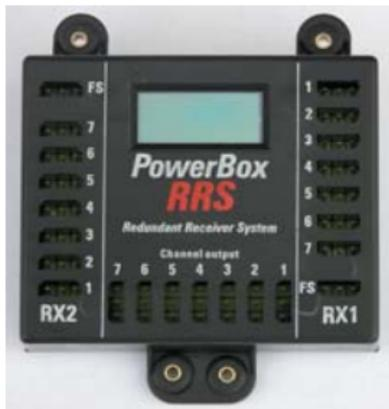
Anschlüsse für 7 Patchkabel von Empfänger 1 (RX 1)
