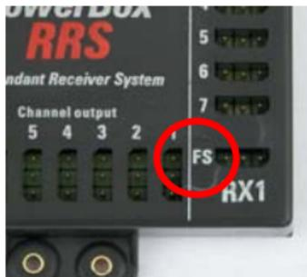
Etwas abgesetzt von den 7 Kanaleingängen beider Empfänger liegt der Steckplatz „Failsafe“, auf dem **RRS**-Modul mit „FS“ beschriftet. Diese Buchse wird von einem Kanal des Empfängers belegt, der von Ihnen im Sender mit Failsafe programmiert wurde.
