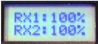
Das nebenstehende Bild zeigt, dass Empfänger 1 und Empfänger 2 richtig arbeiten und beide 100% Empfang aufweisen.
