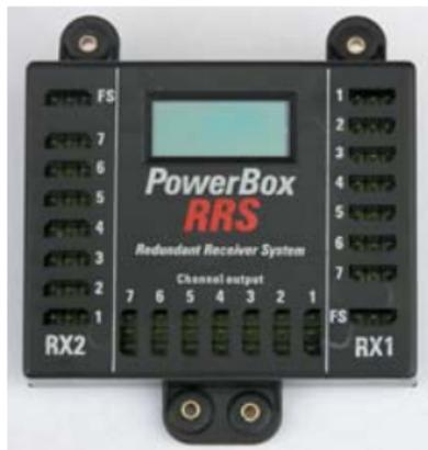
Conectores para los 7 canales del receptor 1 (RX 1), numerados del 1 al 7
