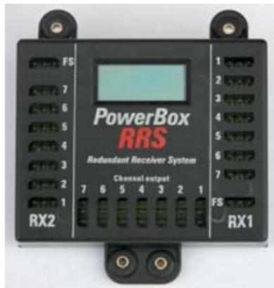
Consejo para los usuarios de Futaba/Robbe con receptores G3: No olvide sincronizar el Segundo receptor en su transmisor como se describe en el Manual de Usuario del equipo de radio, el sistema funciona perfectamente siempre que expresamente se configure el transmisor para funcionar con un Segundo receptor.
