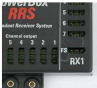
Encontrará las conexiones “Fail-Safe” cerca de las conexiones para los siete canales para ambos receptores, pero ligeramente apartadas; estas conexiones están marcadas con las letras “FS” en el módulo RRS. Estas conexiones deben ser conectadas al canal del receptor PCM donde haya programado el Fail-Safe.
