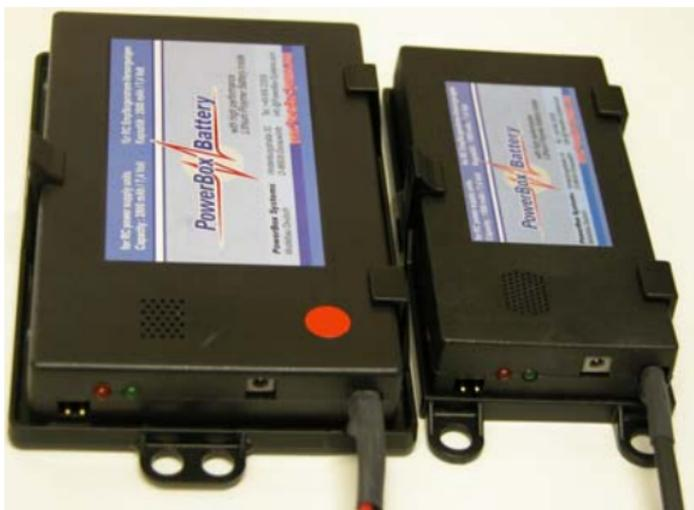
Mit diesen LiPo Akkus bekommen Sie die zur Zeit sichersten Akkupacks, die nicht nur eine komplette Lade- und Sicherheitselektronik beinhalten, sondern auch die beiden Balancer und eine Unterspannungsüberwachung haben.
