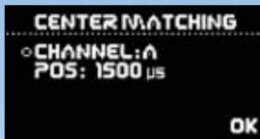
Um ein präzises Servomatching zu gewährleisten muss Ihr Sender in die **PowerBox Professional** initialisiert werden. Es müssen nur die Mittelstellungen der Knüppelkanäle Ihres Senders eingelernt werden. Dazu bringen Sie den Cursor auf „CHANNEL“ und wählen Sie den gewünschten Kanal aus.
